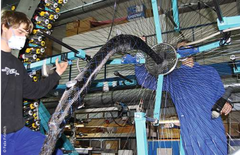
Umflechtanlage zur Herstellung von geflochtenen Preformen.
