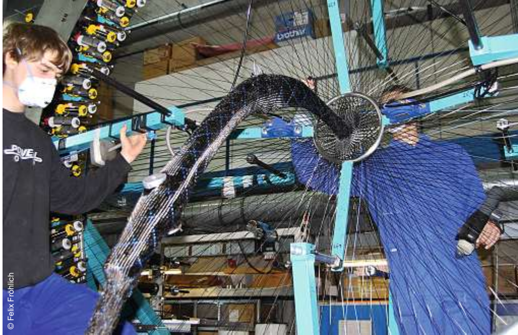
Umflechtanlage zur Herstellung von geflochtenen Preformen.
