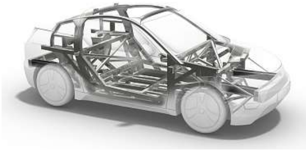
Stabiler Fahrzeugrahmen aus Aluminium
