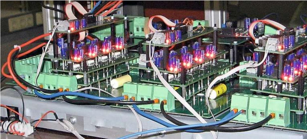
Durch prädiktive Regelungen können solche leistungselektronischen Multilevel-Umwandler präzise und effizient Spannungen und Ströme einstellen.
