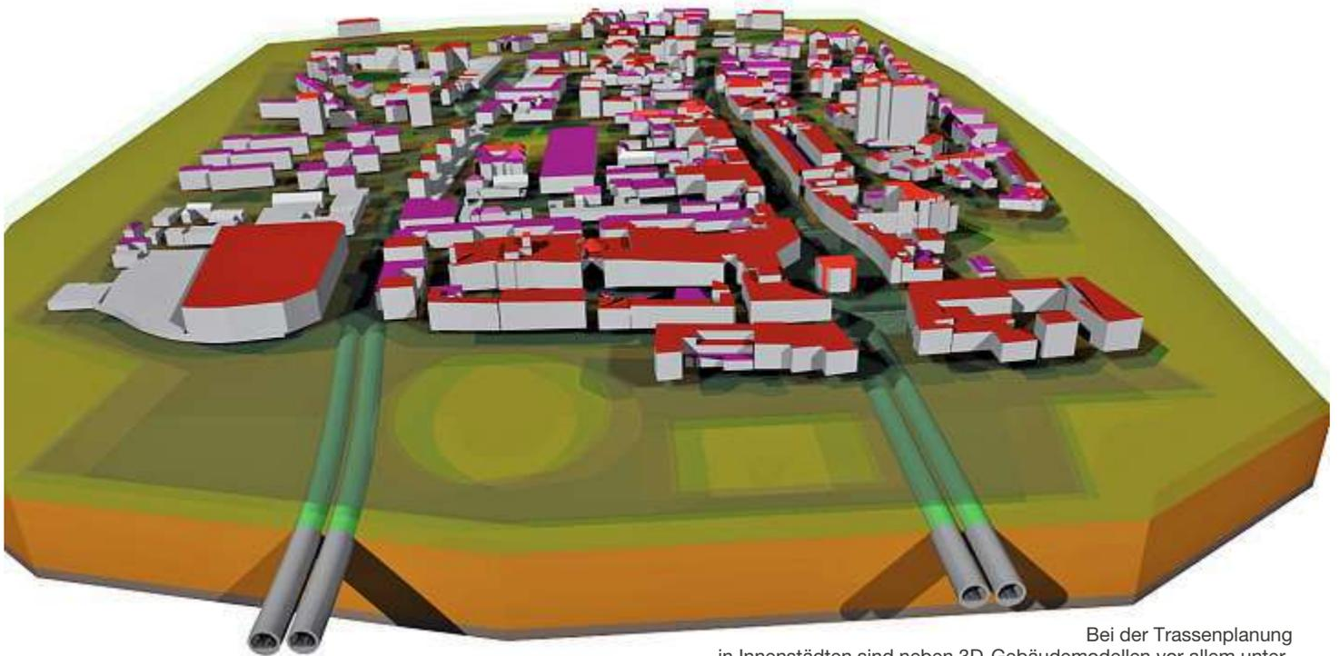
Bei der Trassenplanung in Innenstädten sind neben 3D-Gebäudemodellen vor allem unterirdische Infrastruktureinrichtungen wie Verrohrungen und Kanalanlagen von zentraler Bedeutung.
