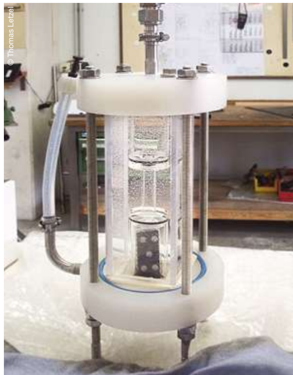
Messzelle mit Diamant-elektroden
