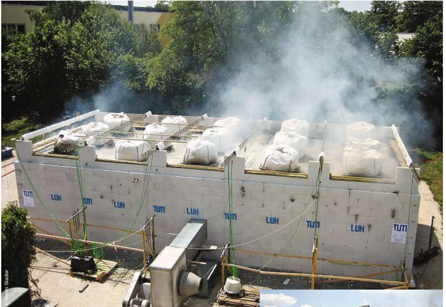
Für die Versuche im Großformat musste eigens ein riesiger Ofen erbaut werden.
