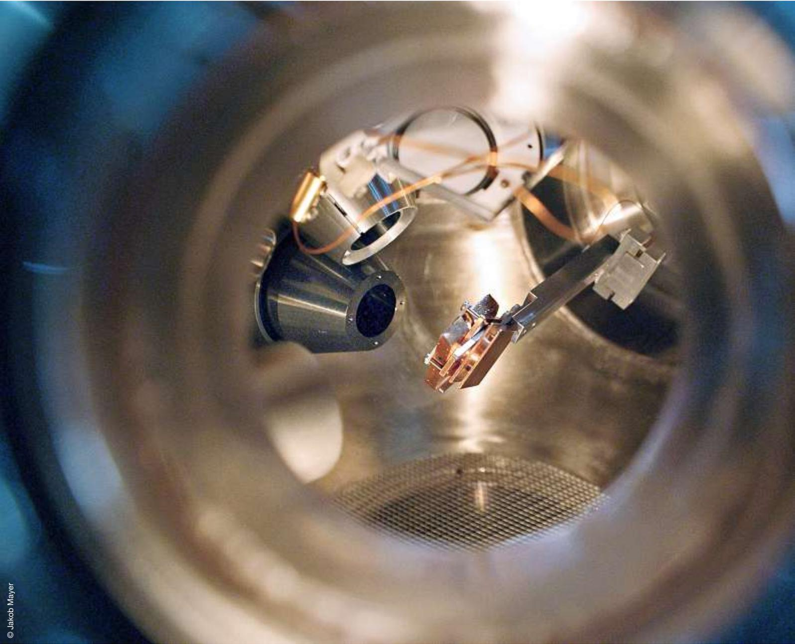
In der Probenkammer der Positronenquelle NEPOMUC am FRM II wird der Positronenstrahl im Ultrahochvakuum auf die Oberfläche einer Probe fokussiert.
