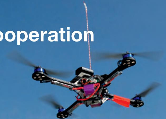
Vier Rotoren: Der Quadrocopter verfügt über ein Regelungssystem zur Stabilisierung des Flugs. Die Antenne für die manuelle Fernsteuerung wird bei automatischem Betrieb nicht benötigt.
