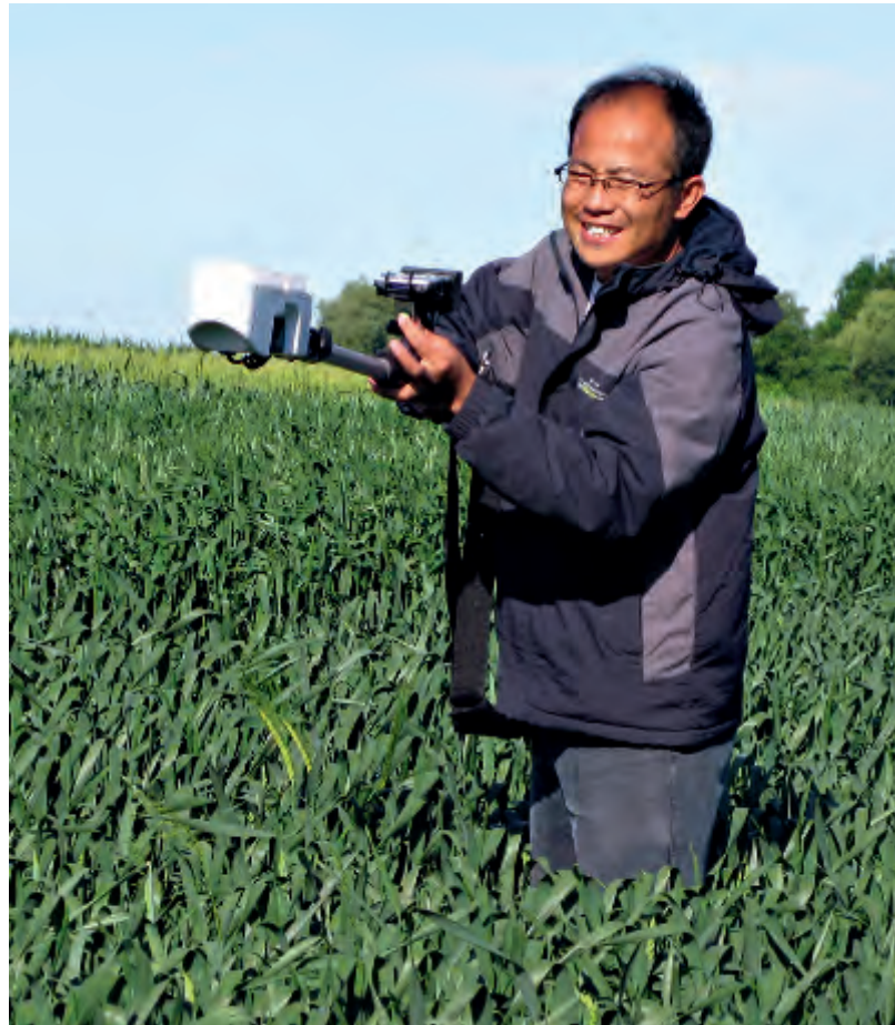
Mit einem tragbaren Sensor misst Post-Doc Dr. Fei Li den Stickstoffstatus eines Ackers mit Winterweizen.
