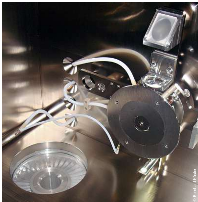
Laser-Optik eines MALDI-Massenspektrometers
