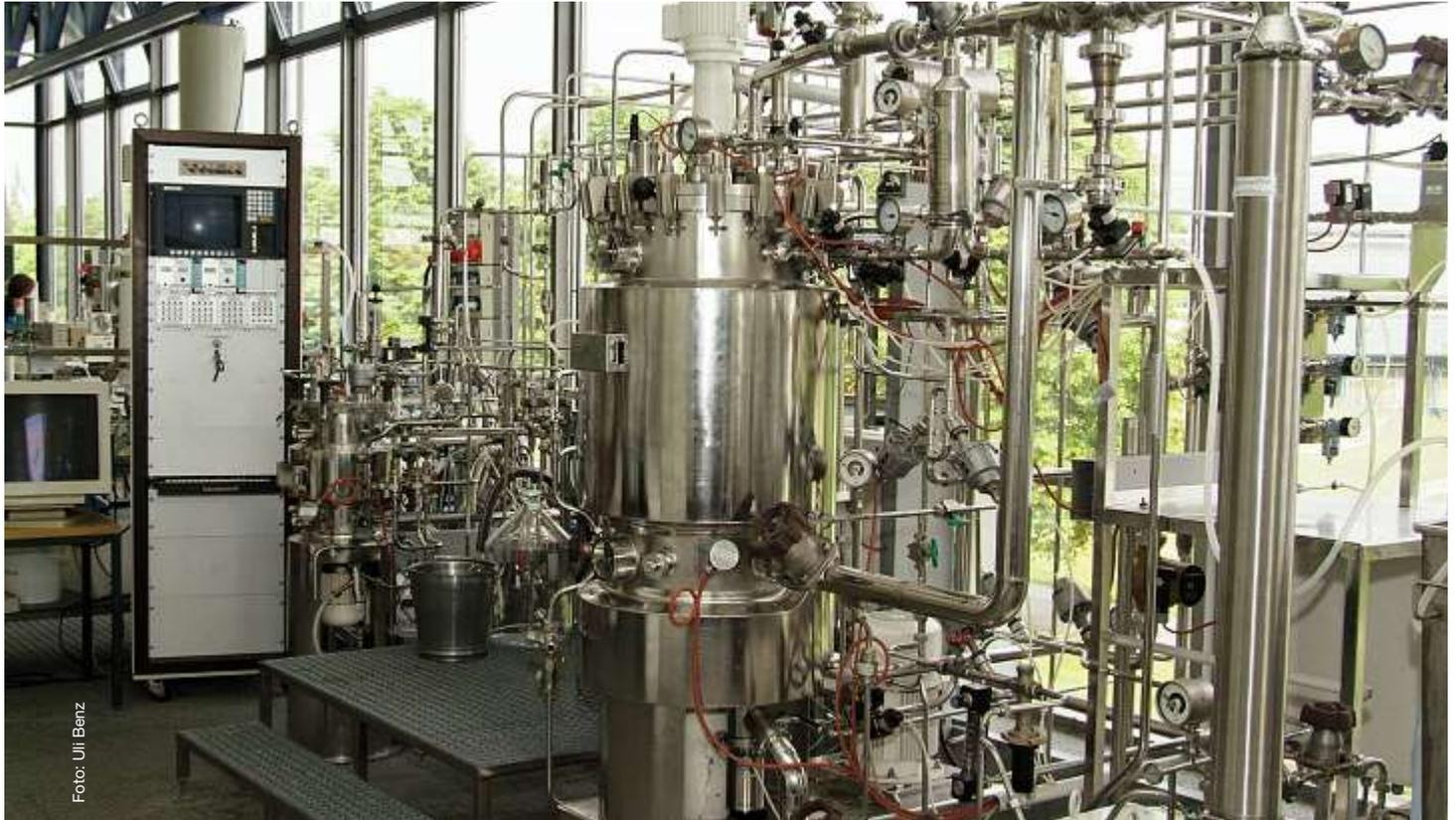
Getränketechnologische Labors arbeiten mit moderner Prozesstechnik. Hier eine Bioreaktoranlage zur Fermentation am Lehrstuhl für Lebensmittelverfahrenstechnik und Molke- reitechnologie.
