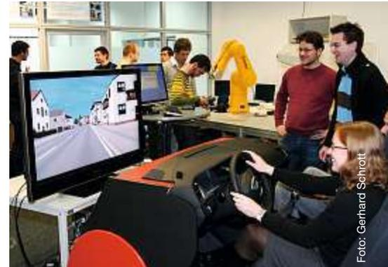
In diesem interaktiven Fahrsimulator können innovative Sicherheits- und Fahrerassistenzfunktionen in einer sehr frühen Entwicklungsphase ausgiebig und ressourcenschonend getestet werden.
