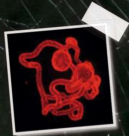
Rekombinant erzeugte Spinnenseidenfäden, sichtbar gemacht durch rote Fluoreszenzfärbung. Die Fäden entstehen in Schmetterlingszellen, deren Ausmaße die Länge der Fäden begrenzen. Durchmesser und Stabilität der Fäden sind identisch mit Originalfäden der Spinne.
