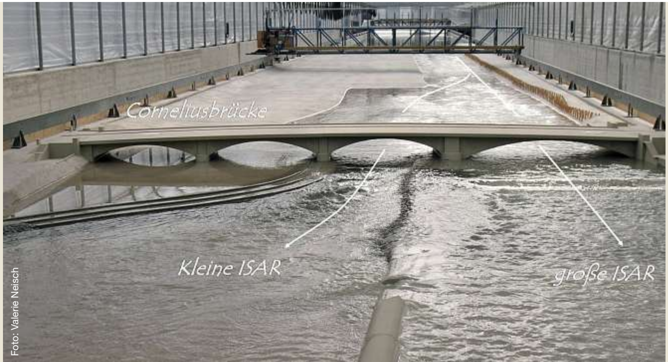
Modellversuch Isarplan im Maßstab 1:20 (Planzustand)
