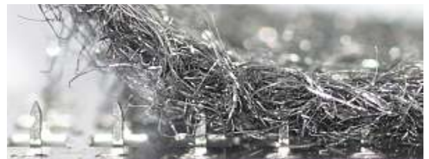
Variante 3: Die Haken, hier etwa 2 mm hoch, greifen in den metallischen Flausch. Durch einfaches Zusammendrücken der beiden Fügepartner verhaken sie sich dort.
