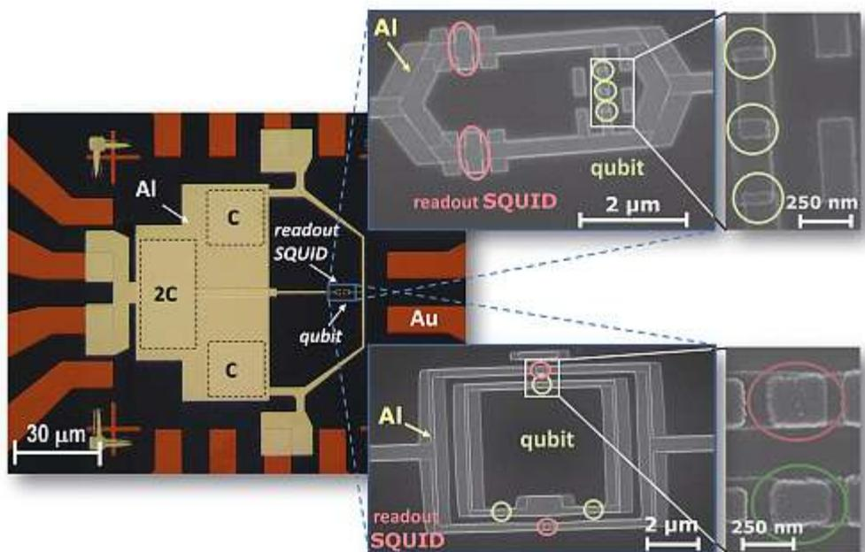
Supraleitender Quantenschaltkreis mit Fluss-Qubit und SQUID-Ausleseeinheit. Rechts sind Ausschnittsvergrößerungen zu sehen.
