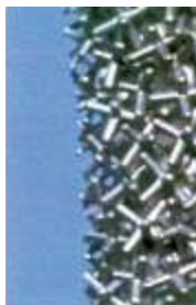
Oberfläche eines Knochenimplantats der Firma ESKA-Implants. Es handelt sich dabei um »Spongiosametall«, in das der Knochen einwächst.
