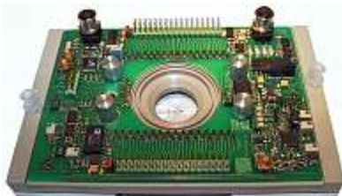
Kammer zur Aufnahme der Glaschips und Auswertung der elektrischen und metabolischen Zellsignale.
