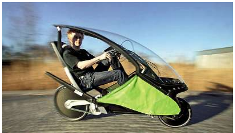
Das Reisefahrrad Läufer basiert auf einem Muskel-Hybrid-Antrieb, der es dem Fahrer erlaubt, sich mit geringem Aufwand schnell im Stadtverkehr zu bewegen. Das Fahrzeug bietet eine ergonomisch optimale Sitzgelegenheit sowie Schutz gegen Wind und Regen. Seit Juli 2006 coacht die UnternehmerTUM das Team und begleitet es auf dem Weg zur Gründung eines Unternehmens. Foto: Läufer
