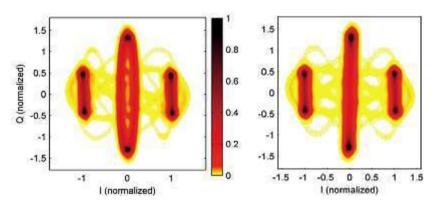
Die IQ-Diagramme für das E1-Signal von GIOVE-A im Januar 2006 (links) und heute (rechts) weisen deutliche Unterschiede auf. Das heutige Signal ist nahezu ideal. Leichte Unterschiede in der Ausrichtung des inneren und äußeren Balkens lassen sich durch die nicht-lineare Charakteristik des Leistungsverstärkers erklären.
