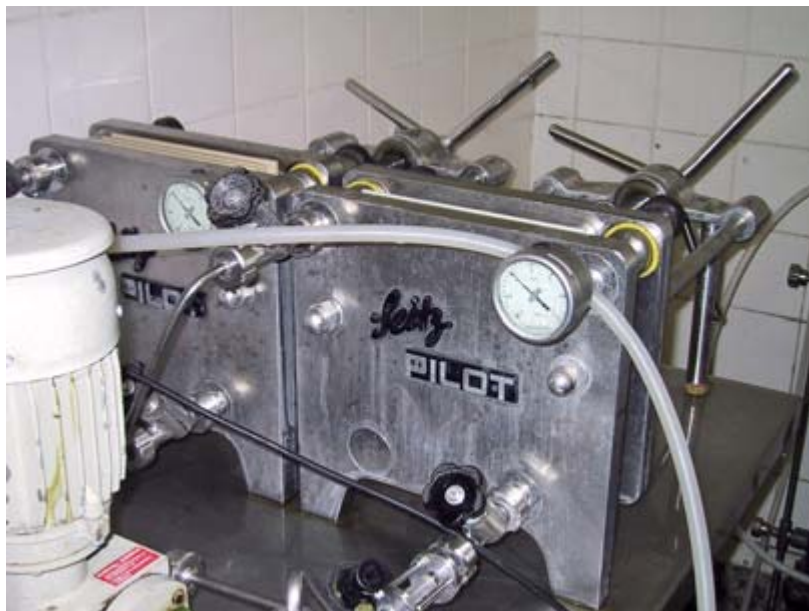
Pilotfilter zur Bierfiltration am Lehrstuhl für Technologie der Brauerei II
