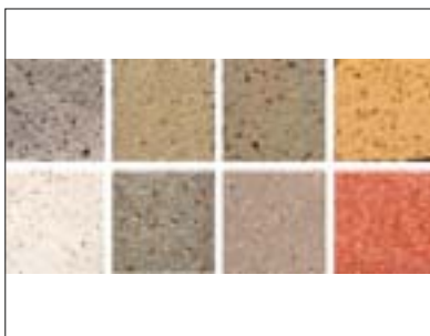
Holzleichtbeton-Oberflächen. Links oben: HLB, unten: HLB mit Weißzement; mittlere vier Quadrate: HLB und PCM; rechts eingefärbter HLB und PCM: oben 5 Prozent Gelb, unten 5 Prozent Rot.
