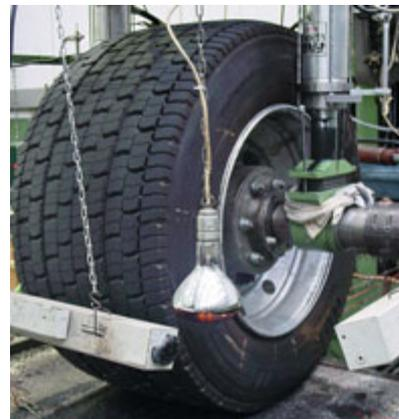
Der Superbreitreifen 495/45 R 22,5 im Rollprüfstand. Mit seinen stattlichen Abmessungen - etwa 1 m hoch und 50 cm breit - kann er über eine große Aufstandsfläche hohe Lasten abtragen.
