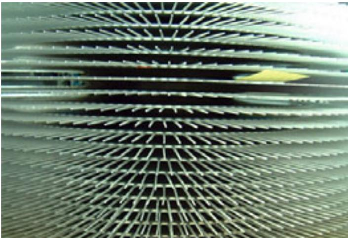
Ansicht von Selektorscheiben wie sie in einem Neutronengeschwindigkeitsfilter eingesetzt werden. Durch Verwendung dieses Filters in Neutronenbeugungsexperimenten kann der Untergrund von an der Probe ungewünschten Neutronengeschwindigkeiten erheblich reduziert werden. Dies führt zu einem weniger verrauschten Signal im Neutronendetektor und somit zu qualitativ besserer Daten. Lesen sie dazu den Bericht auf Seite 63.
