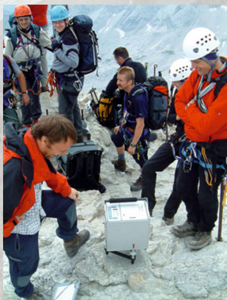
Schweremessung mit einem Federgravimeter am Zugspitzgipfel. Foto: Martin Schmeer
