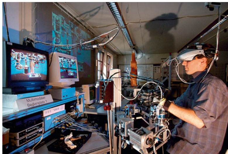
Der mit zwei Greifarmen ausgestattete Steuerungsapparat erlaubt ein Hantieren aus sicherer Entfernung.
