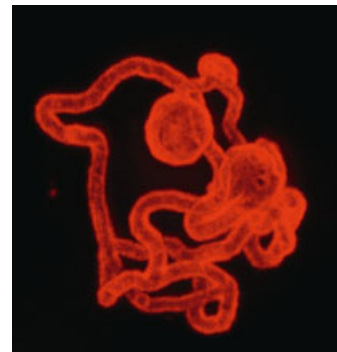
Rekombinant erzeugte Spinnenseidenfäden, sichtbar gemacht durch Fluoreszenzfärbung. Die Fäden entstehen in Schmetterlingszellen, deren Ausmaße die Länge der Fäden begrenzen. Durchmesser und Stabilität der Fäden sind identisch mit Originalfäden der Spinne.
