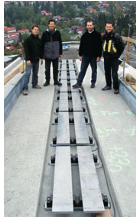
Das von der TUM mitentwickelte Kraftmessplattensystem besteht aus je sieben einzelnen Platten für die linke und die rechte Anlaufspur (2.v.r. Prof. Ansgar Schwirtz).
