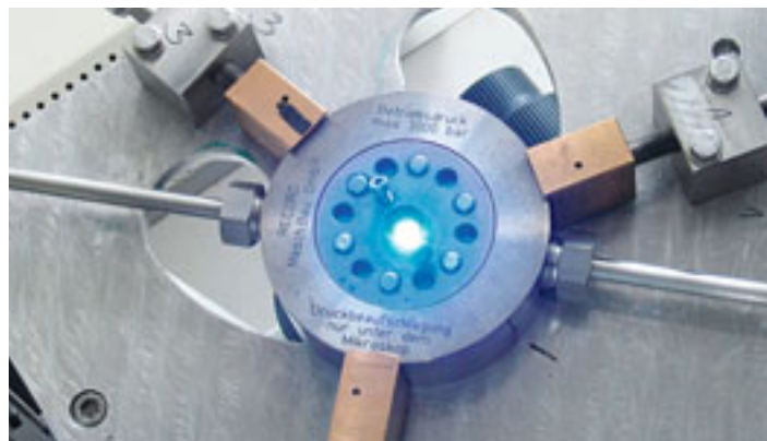
Die an ein Fluoreszenzmikroskop adaptierte Hochdruckzelle.
