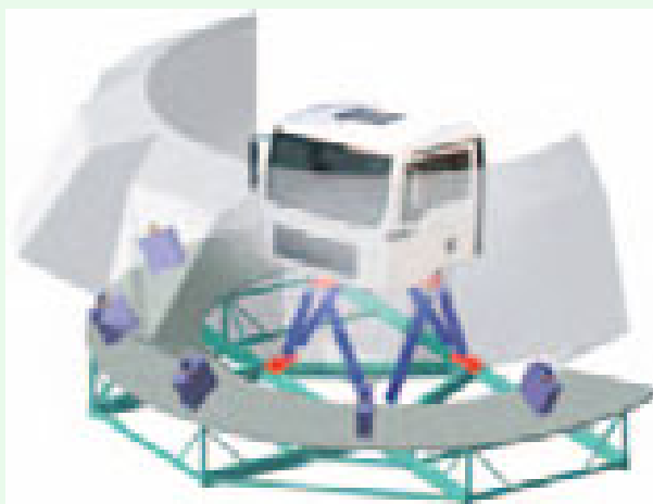
Das Fahrerhaus ist auf einer mit sechs Stellzylindern bewegten Plattform montiert, die zum Fahrzustand passende Nick- und Wankbewegungen sowie geringe Längs- und Querbeschleunigungen ausführt.
