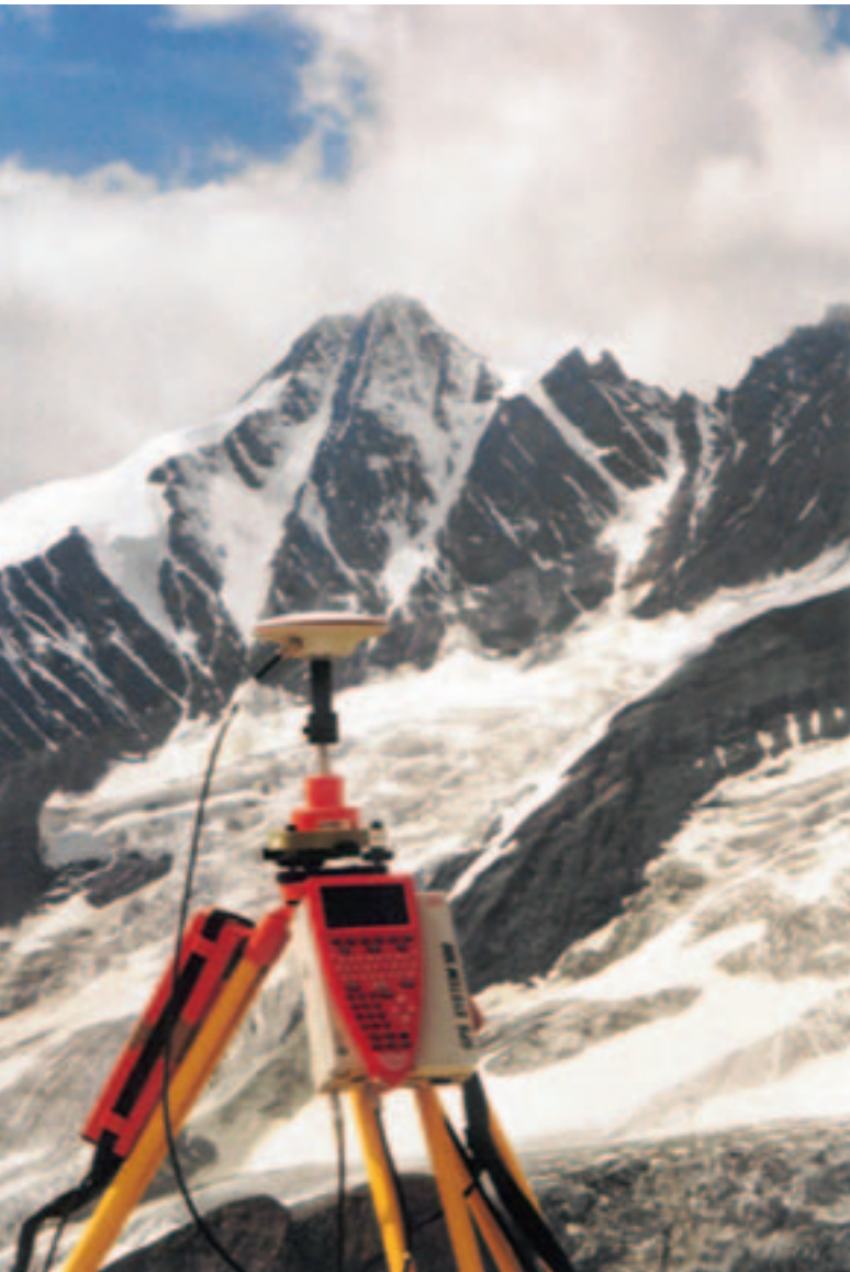
Der hochpräzise GPS-Empfänger Leica SR530 bei seinem ersten Einsatz in der Messkampagne zur integralen Höhenbestimmung des Großglockners im September 2000. Foto: Thomas Wunderlich
