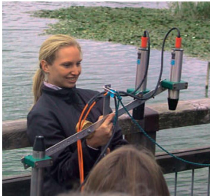
Das Unterwasser-Spektralmesssystem RAMSES dient den Untersuchungen am Waging-Tachinger See.
