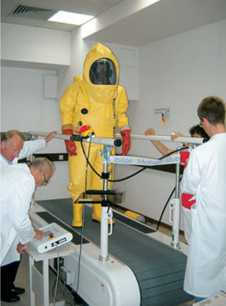
Die Laufbandtests ergaben: In erster Linie verbessert die externe Luftzufuhr das Binnenklima der Schutzanzüge. Das empfinden die Feuerwehrleute als entlastend.
