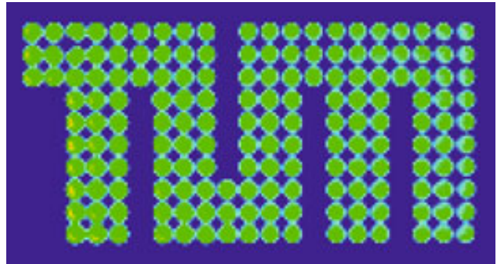
Modell-Microarray zur Darstellung des TUM-Logos (Falschfarbendarstellung). Die Spots haben einen Abstand (Mitte zu Mitte) von 0.5 mm. Die Reagenzien wurden auf einem Glasobjektträger immobilisiert.
