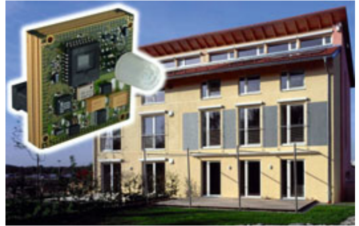
Vollständig aufgebauter Mikrosystemstapel der Bluetooth-Überwachungskamera mit einer Kantenlänge von 40 mm. Im Hintergrund ist das Versuchshaus in Neubiberg zu sehen, das jedes Wochenende besichtigt werden kann.
