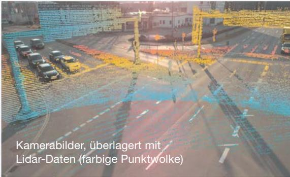
Kamerabilder, überlagert mit Lidar-Daten (farbige Punktwolke)
