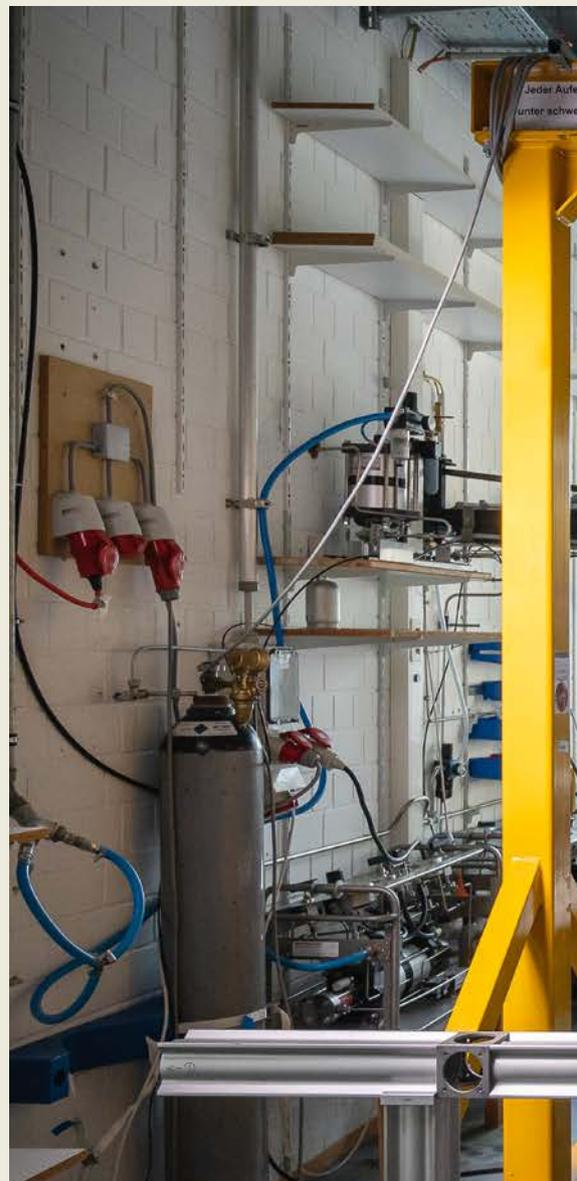
Zunächst wollen wir die thermoakustischen Auswirkungen wie Lärm und Vibrationen an einem modularen Teststand erforschen, den wir derzeit von Kerosin auf Wasserstoff umrüsten. Ein erster Demonstrator mit Wasserstoff-Brennkammer soll in einigen Jahren fliegen.
