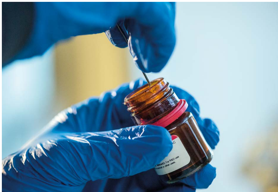
Vorbereitende Schritte, um Moleküle auf eine Oberfläche zu verdampfen: Cobalt-Phthalocyanin-Moleküle werden von einem Behälter in einen Quarztiegel übertragen.
