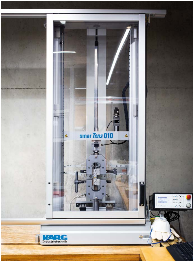
Universalprüfmaschine zur Messung von Zugscherversuchen und Zugversuchen an Klebungen.
