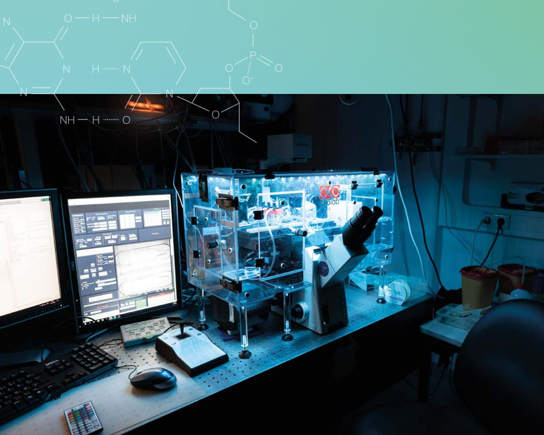
Fluoreszenzmikroskop mit Mikrofluidikaufbau für die Untersuchung von synthetischen biochemischen „Schaltkreisen“.
