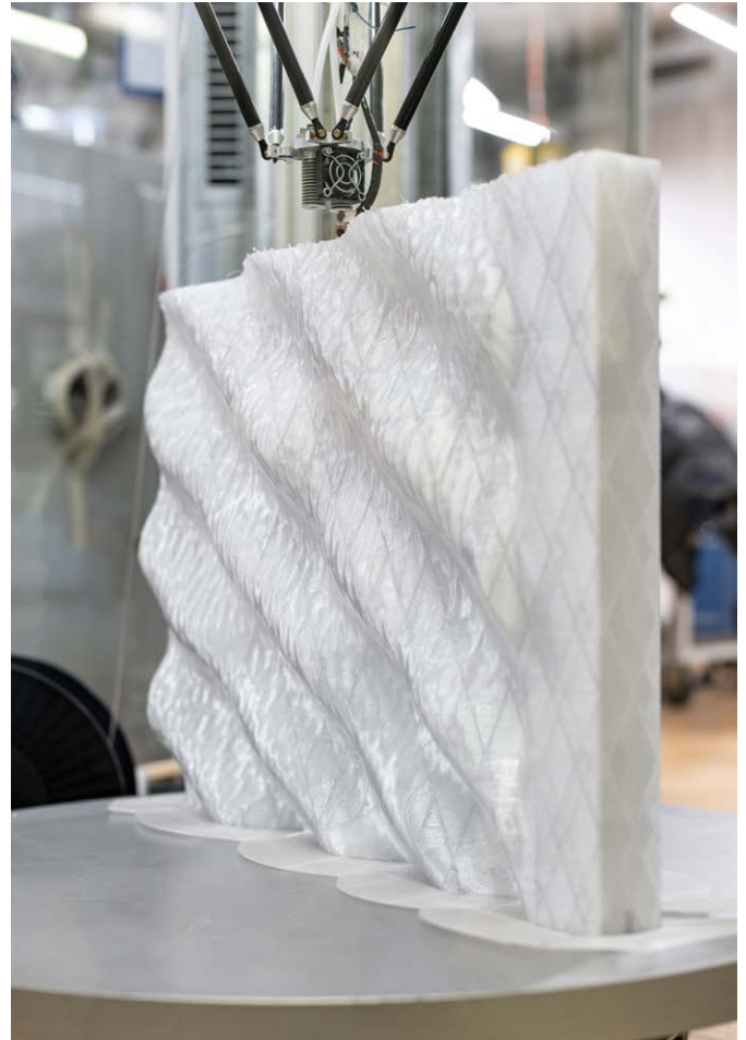
3D-Druck eines Fassadenelements (ca. 80 x 90cm) mit einem Großformat Delta Drucker im Technischen Zentrum der Fakultät für Architektur der TUM.
