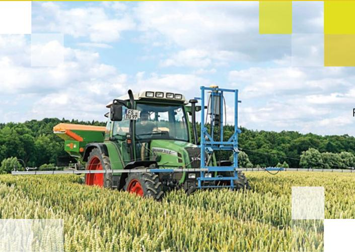
**Vorne messen, hinten streuen:** Sensoren am Gestänge vorne am Traktor erfassen die aktuellen Reflexionswerte, der Computer verrechnet sie in Echtzeit und steuert mit den Werten punktgenau den hinten angebrachten Düngestreuer. Unten das Reflexionsspektrum eines Pflanzenbestandes.
