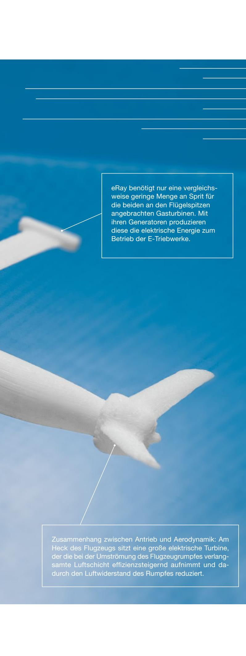
eRay benötigt nur eine vergleichsweise geringe Menge an Sprit für die beiden an den Flügelspitzen angebrachten Gasturbinen. Mit ihren Generatoren produzieren diese die elektrische Energie zum Betrieb der E-Triebwerke.
