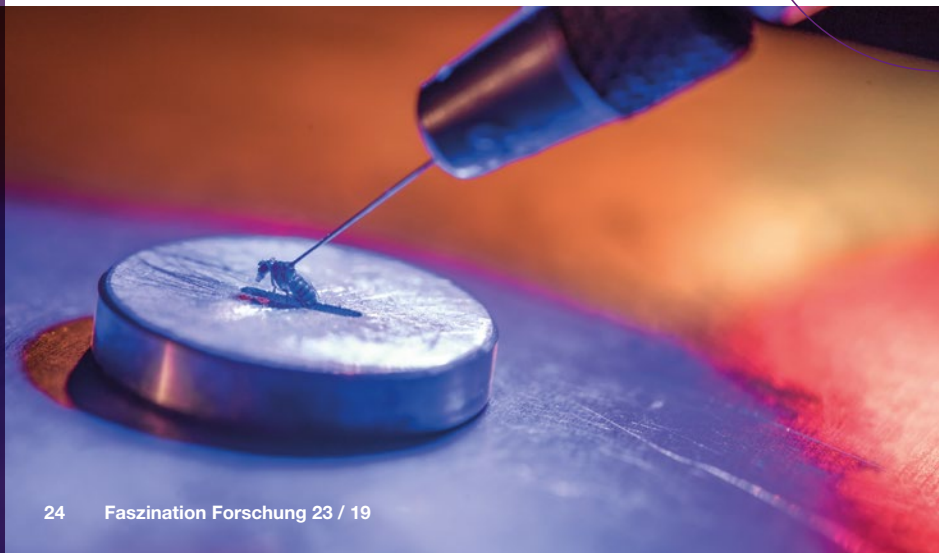
Die Fliegen werden mit Kälte oder CO 2 anästhesiert und dann mit Pinzetten und Mikromanipulatoren unter dem Mikroskop bewegt. Festgeklebt werden sie mit UVgehärtetem Dentalkleber, der extrem schnell härtet.
