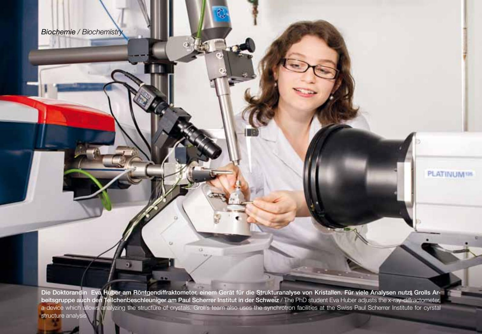
Die Doktorandin Eva Huber am Röntgendiffraktometer, einem Gerät für die Strukturanalyse von Kristallen. Für viele Analysen nutzt Grolls Arbeitsgruppe auch den Teilchenbeschleuniger am Paul Scherrer Institut in der Schweiz / The PhD student Eva Huber adjusts the x-ray-diffractometer; a device which allows analyzing the structure of crystals. Groll's team also uses the synchrotron facilities at the Swiss Paul Scherrer Institute for crystal structure analysis
