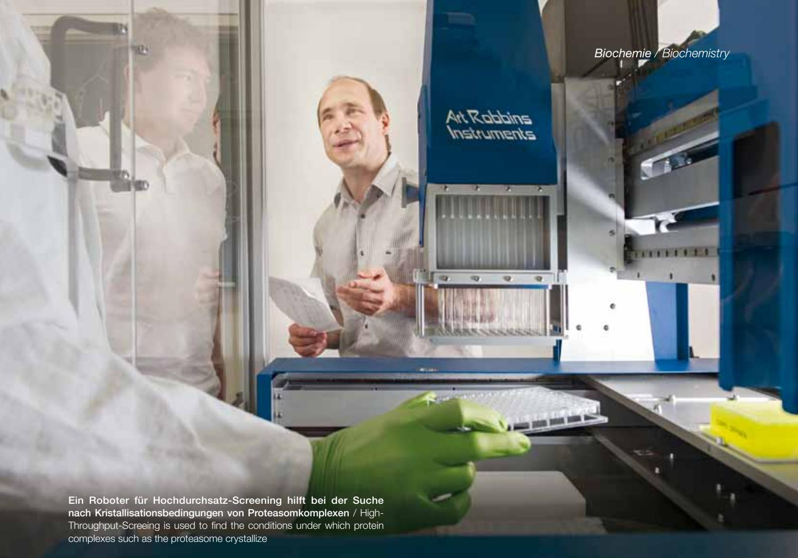
Ein Roboter für Hochdurchsatz-Screening hilft bei der Suche nach Kristallisierungsbedingungen von Proteasomkomplexen / High-Throughput-Screeing is used to find the conditions under which protein complexes such as the proteasome crystallize
