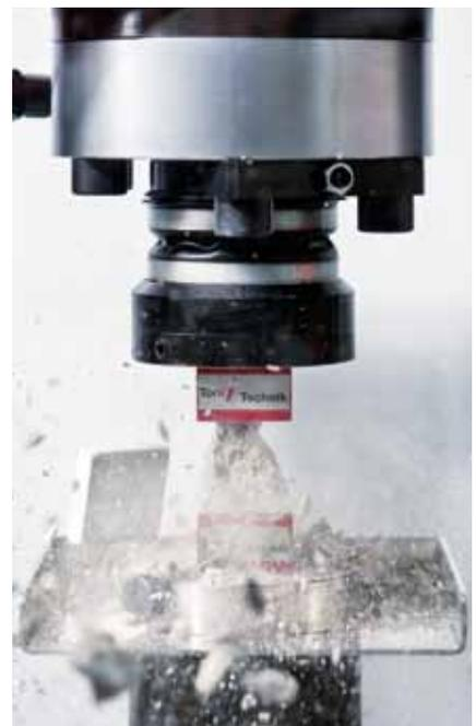
Ende eines Druckfestigkeitstests: Ein Probenkörper versagt in der hydraulischen Presse
