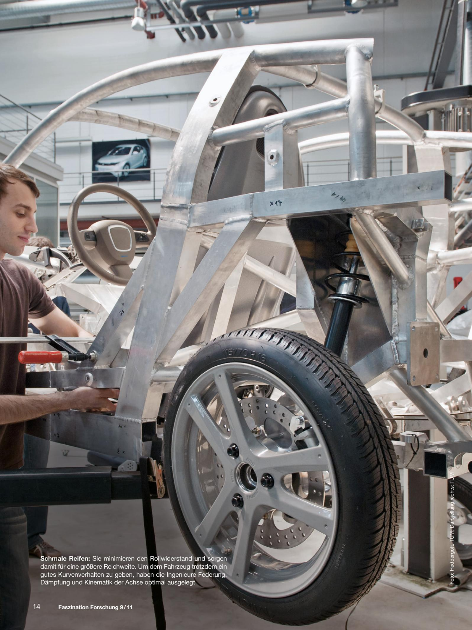
**Schmale Reifen:** Sie minimieren den Rollwiderstand und sorgen damit für eine größere Reichweite. Um dem Fahrzeug trotzdem ein gutes Kurvenverhalten zu geben, haben die Ingenieure Federung, Dämpfung und Kinematik der Achse optimal ausgelegt
