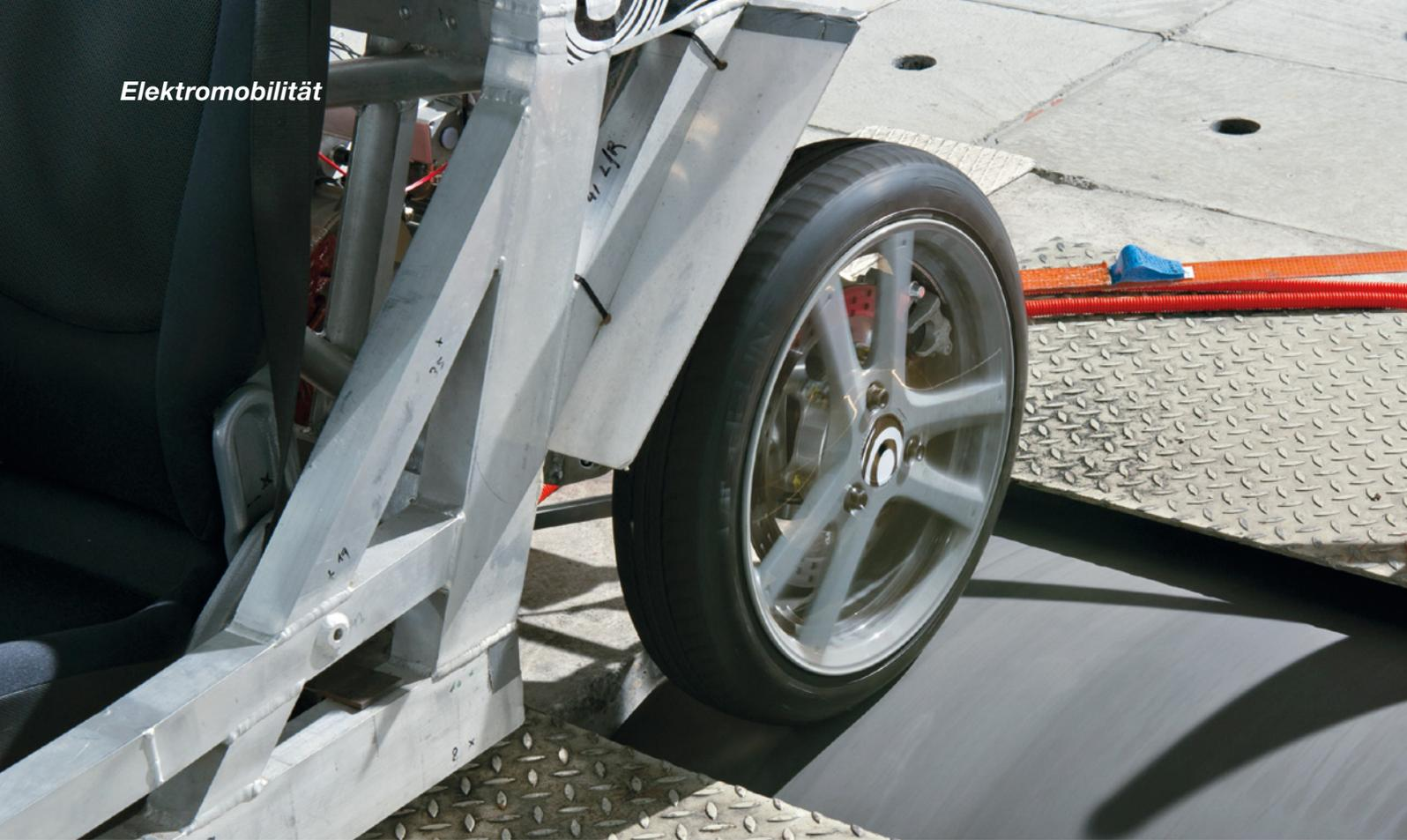
**Auf dem Rollenprüfstand** am Lehrstuhl für Fahrzeugtechnik musste sich MUTE in der Entwicklungsphase vielen Tests unterziehen, bis die Ingenieure mit der Leistung von Antrieb und Bremse zufrieden waren
