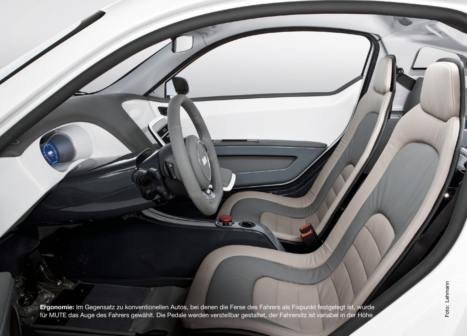
**Ergonomie:** Im Gegensatz zu konventionellen Autos, bei denen die Ferse des Fahrers als Fixpunkt festgelegt ist, wurde für MUTE das Auge des Fahrers gewählt. Die Pedale werden verstellbar gestaltet, der Fahrersitz ist variabel in der Höhe
