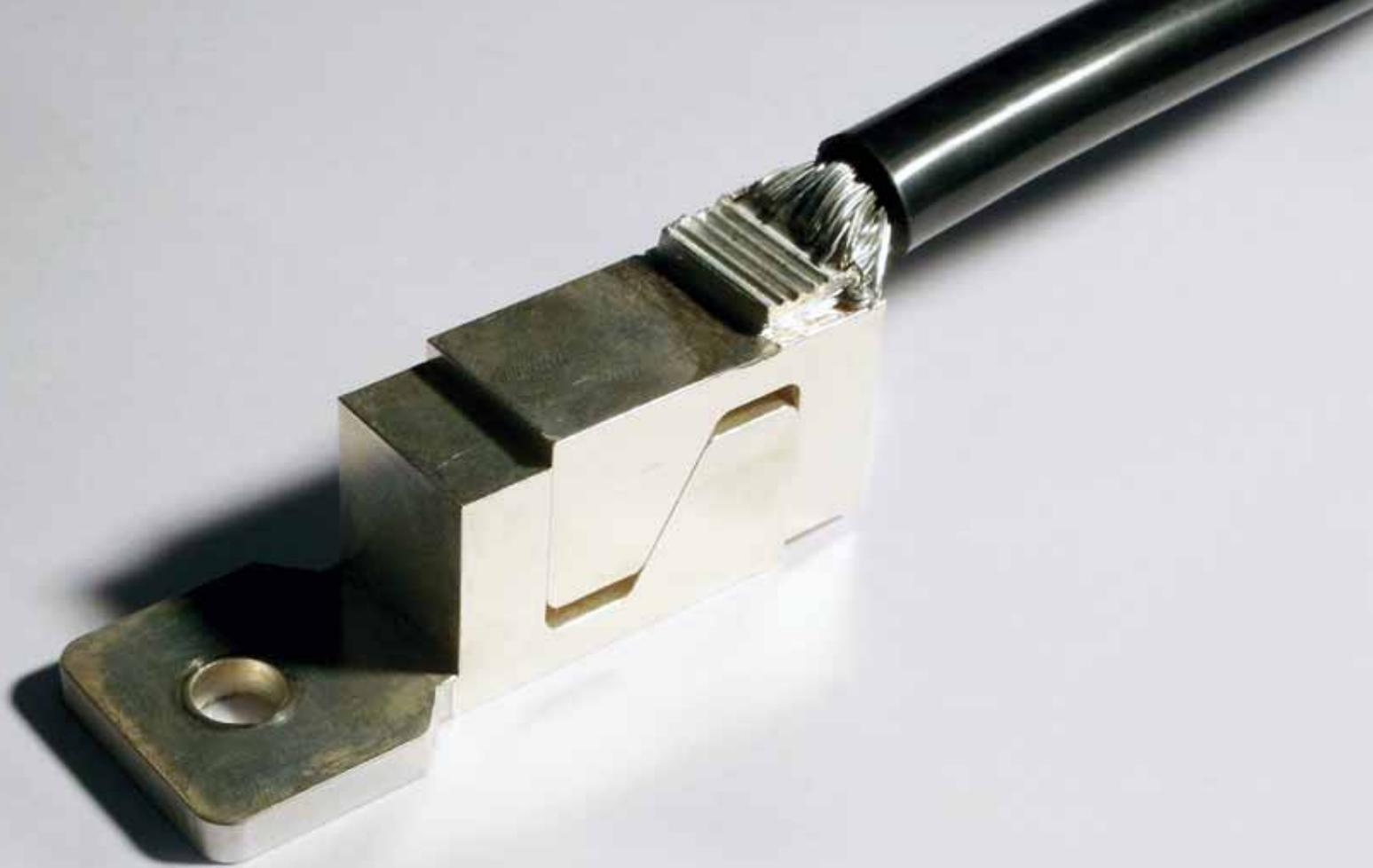
**Die keilförmigen Kontaktstellen greifen wie Haken ineinander.** Besonderes Augenmerk legen die Forscher auf die Verbindung zwischen Aluminiumkabel und Kontaktelement. Um sicheren Halt zu gewährleisten, wenden sie unter anderem Ultraschall-Schweißverfahren an
