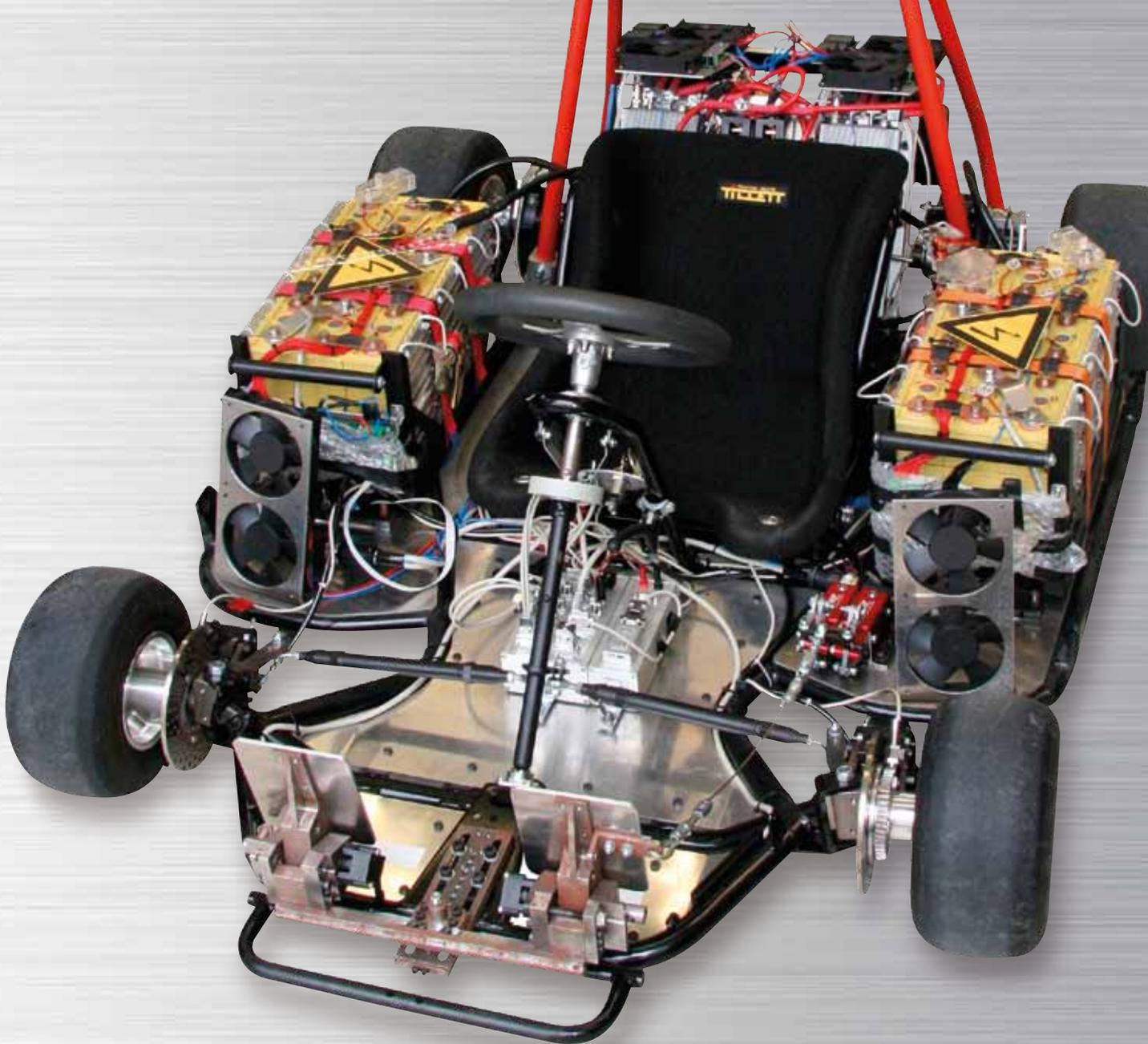
**Das eKart ist ein studentisches Projekt** am Lehrstuhl für Produktentwicklung zum Bau eines vollständig elektrifizierten Gokarts. Das Fahrzeug dient als Demonstratorobjekt und Entwicklungsplattform für die verschiedenen Module – darunter auch das Hochvoltbordnetz
