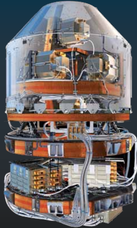
Das Herz des Satelliten: Im oberen Teil befinden sich die drei Gradiometrie-Messgeräte, darunter die Computer
