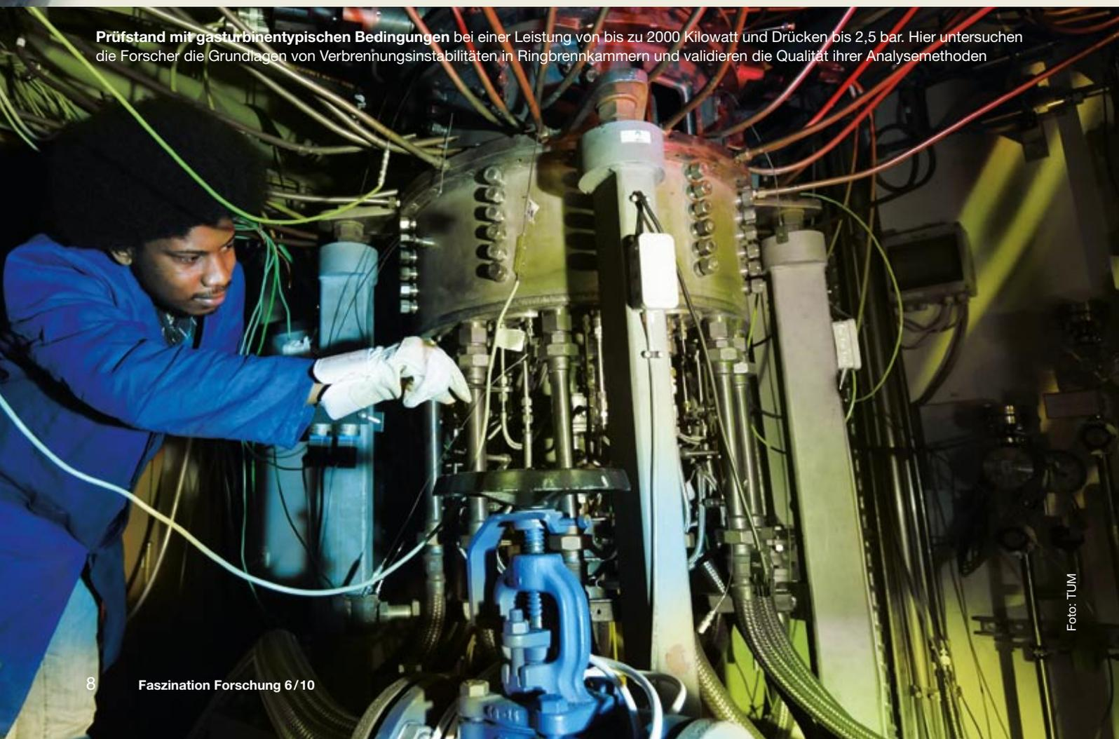
**Prüfstand mit gasturbinentypischen Bedingungen** bei einer Leistung von bis zu 2000 Kilowatt und Drücken bis 2,5 bar. Hier untersuchen die Forscher die Grundlagen von Verbrennungsinstabilitäten in Ringbrennkammern und validieren die Qualität ihrer Analysemethoden
