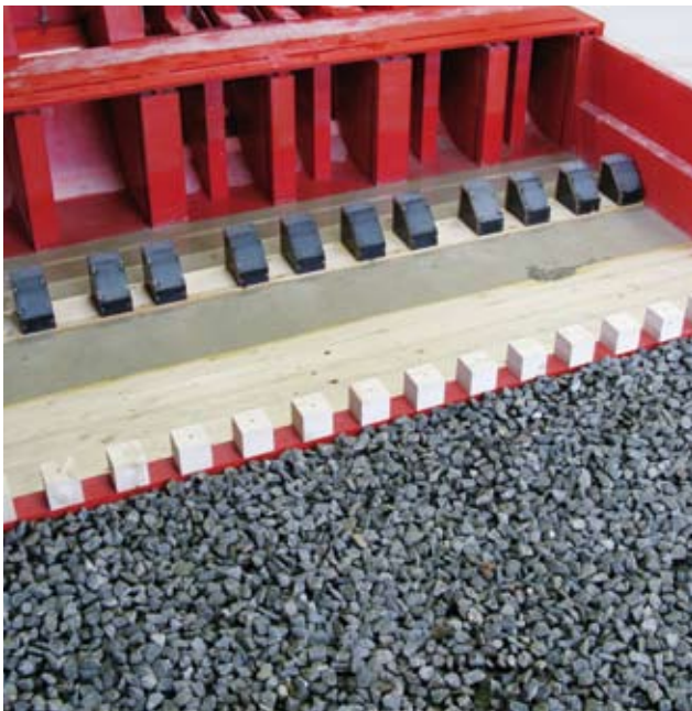
Tosbecken mit optimierten Einbauten zur Verbesserung der Energieumwandlung
