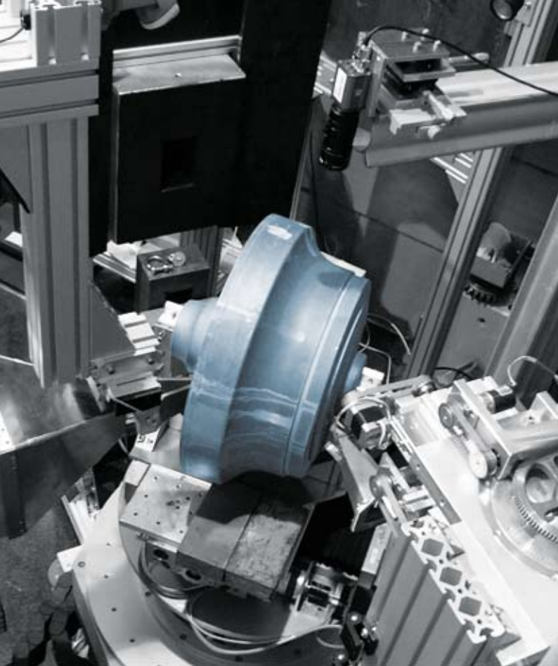
Links der mehr als drei Zentner schwere Aluminium-Rohling bei der Messung in STRESS-SPEC. Rechts richtet der Techniker Günther Seidl ein Verdichterrad millimetergenau für die Messung ein
