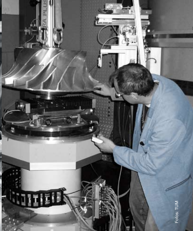
Links der mehr als drei Zentner schwere Aluminium-Rohling bei der Messung in STRESS-SPEC. Rechts richtet der Techniker Günther Seidl ein Verdichterrad millimetergenau für die Messung ein
