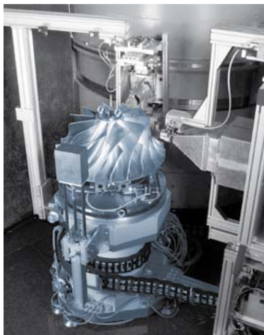
Die Anlage STRESS-SPEC am Forschungsreaktor Garching kann metallische Objekte mit Hilfe von Neutronen durchleuchten und Spannungen in ihrem Inneren darstellen – hier bei einem Verdichterrad
