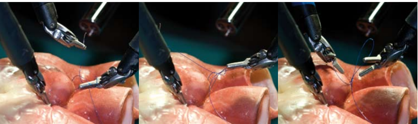
Die haptische Ausstattung des Telemanipulators hat sich in den Versuchen bewährt: Das Gewebe wird weniger stark zerstört und beim chirurgischen Knoten treten weniger Fadenrisse auf
